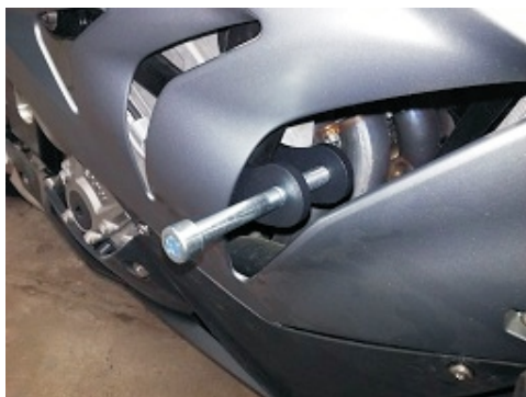
Miejsce montażu (prawa strona)
